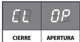
! En caso de que el display no coincida con el movimiento del portón, cambie el parámetro de dirección de apertura en P0->d1 a 1
